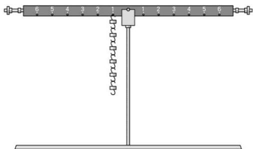
(1)將支點左邊第一格當作抗力點，掛上六個等重砝碼，支點右邊當作施力點，使槓桿平衡。施力點在第( 1 )格時，施力點和抗力點掛的砝碼一樣多。
